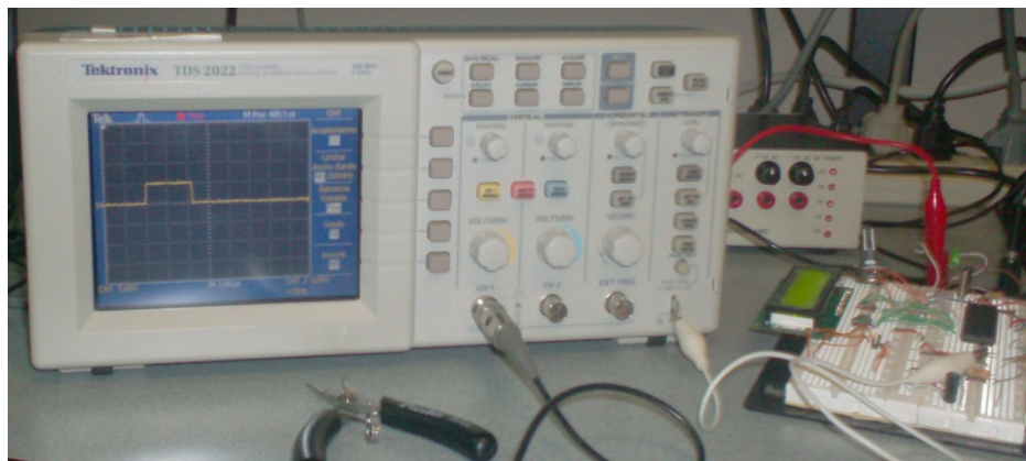
FIGURA 18.a: Datos reales del PULSOUT en Osciloscopio
