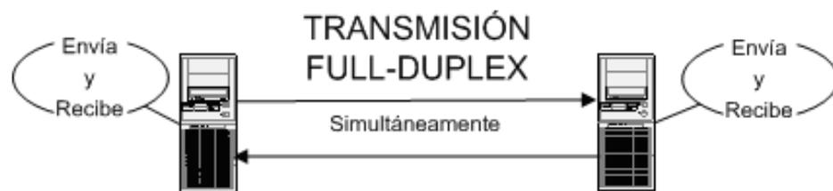
**Figura 2.3 Comunicación serial: Full Duplex**
