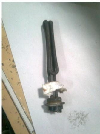
**FIGURA 3.15. RESISTENCIA DE CALDERA DE VAPOR**
