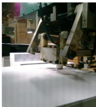
**FIGURA 3.10. BOTELLA NEUMÁTICA DE LA ENGOMADORA**
