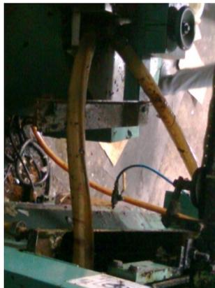
**FIGURA 3.11. FUGA DE ACEITE EN MANGUERAS**
