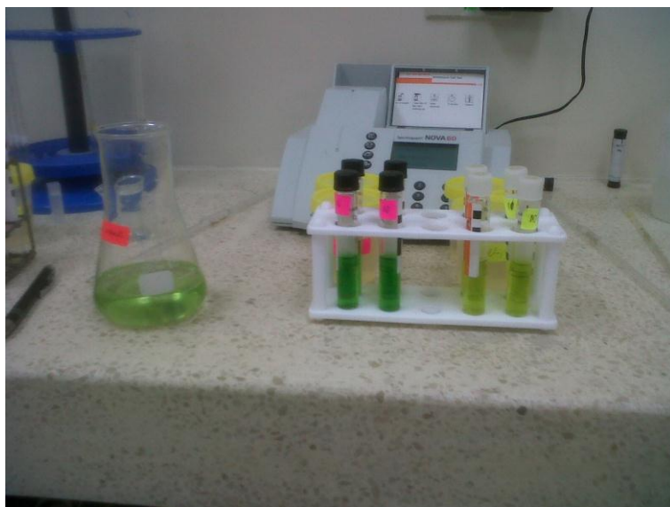
Figura 4.8: Fotografía del espectrofotómetro Spectroquant Nova 60 con los tubos de ensayo durante un ensayo de lectura.
