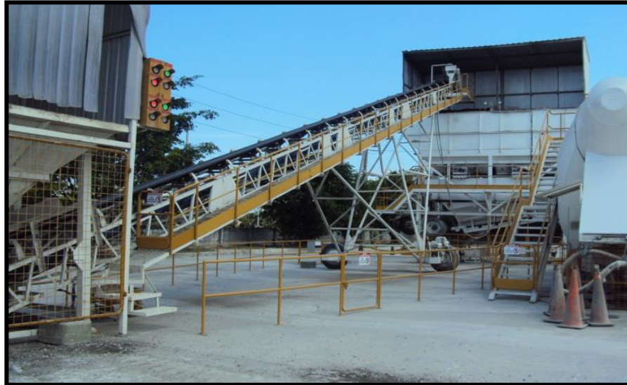
Ilustración 7. 8 Compartimentos para la Ubicación de Agregados Planta.
