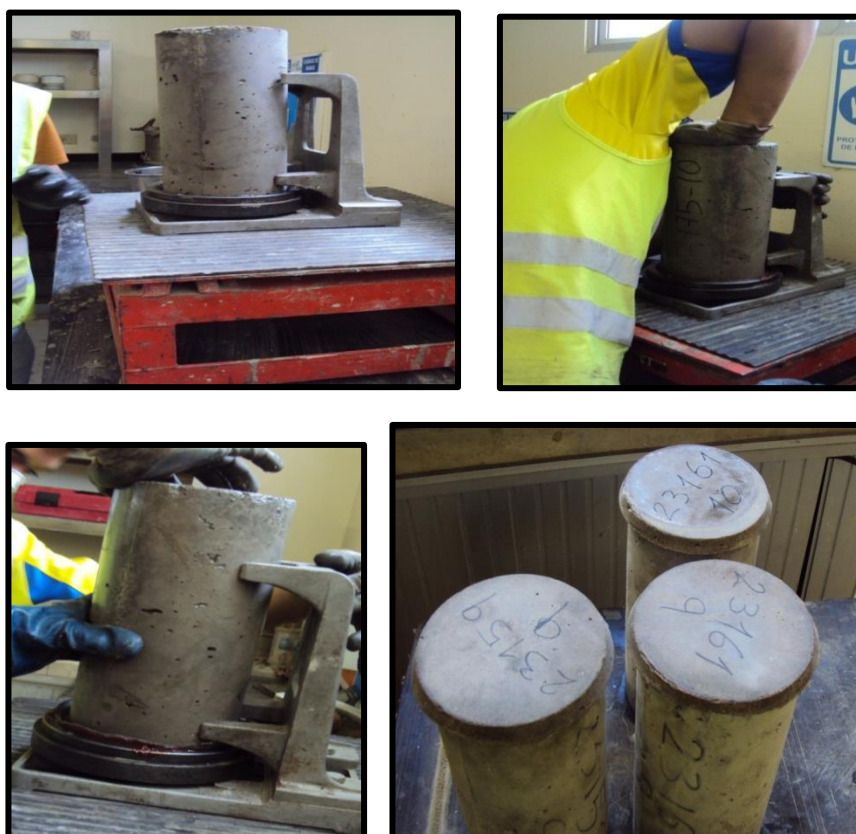
Ilustración 5. 4 Proceso de Vibración y Acabado del Refrentado.
