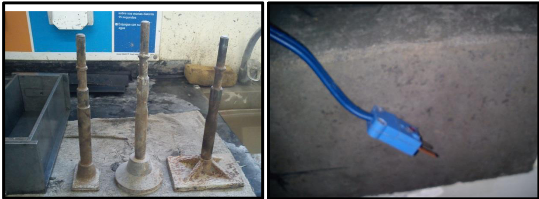
Ilustración 5. 12 Apisonadores y Termocuplas.
