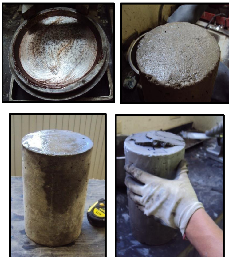
Ilustración 5. 3 Colocación de Mortero a los Especímenes.
