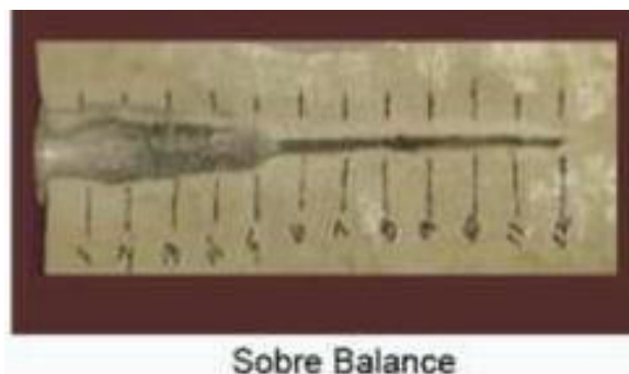
Figura 2.8 Disparos en sobrebalance Fuente: Halliburton
