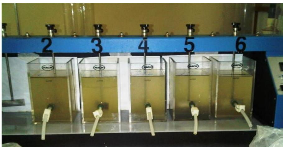
**Figura 3. 8 Determinación pH óptimo, prueba de jarras #1**
