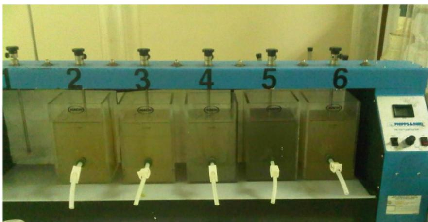
**Figura 3. 7 Equipo utilizado, jar test Phipps & Bird PB 750**
