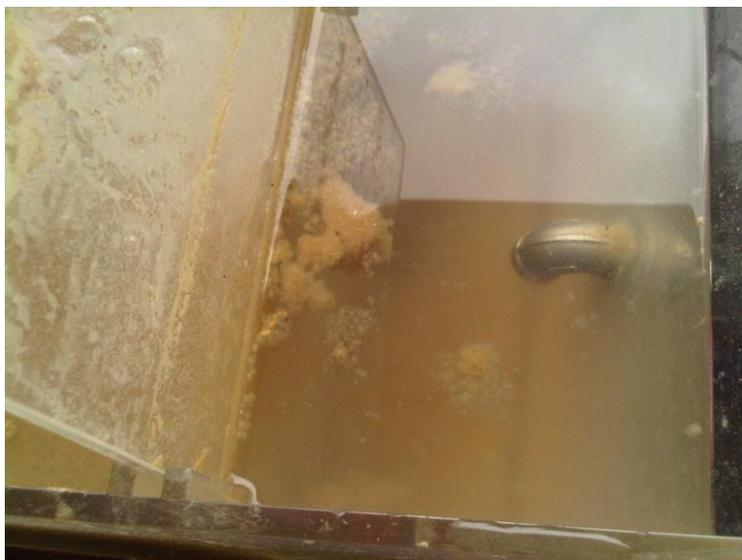
**Figura 3. 2 Resuspensión de lodos, reactor continuo**
