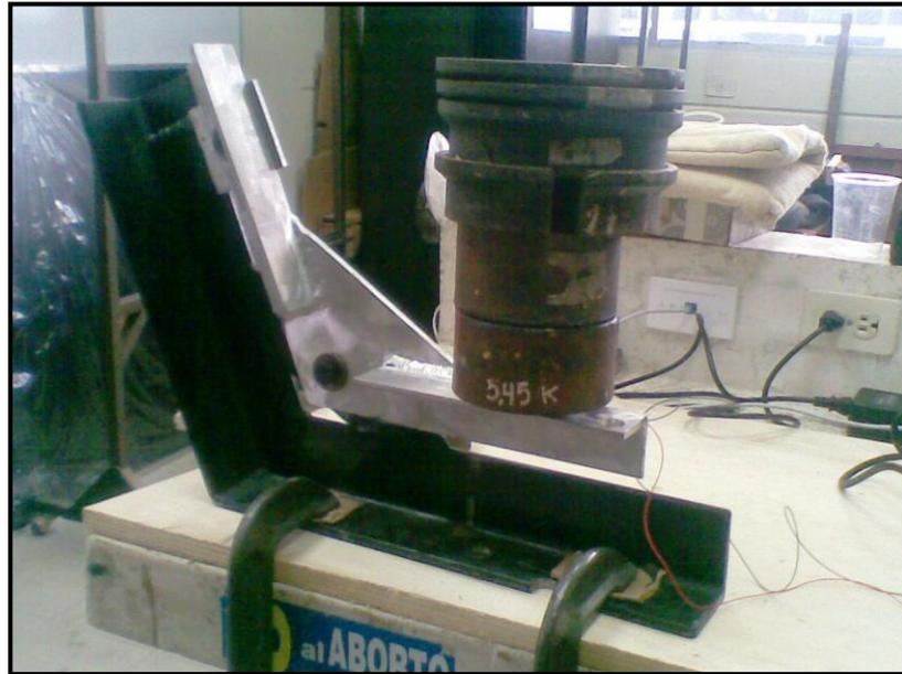
Figura No. 33 Aplicación Preliminar de carga concentrada
