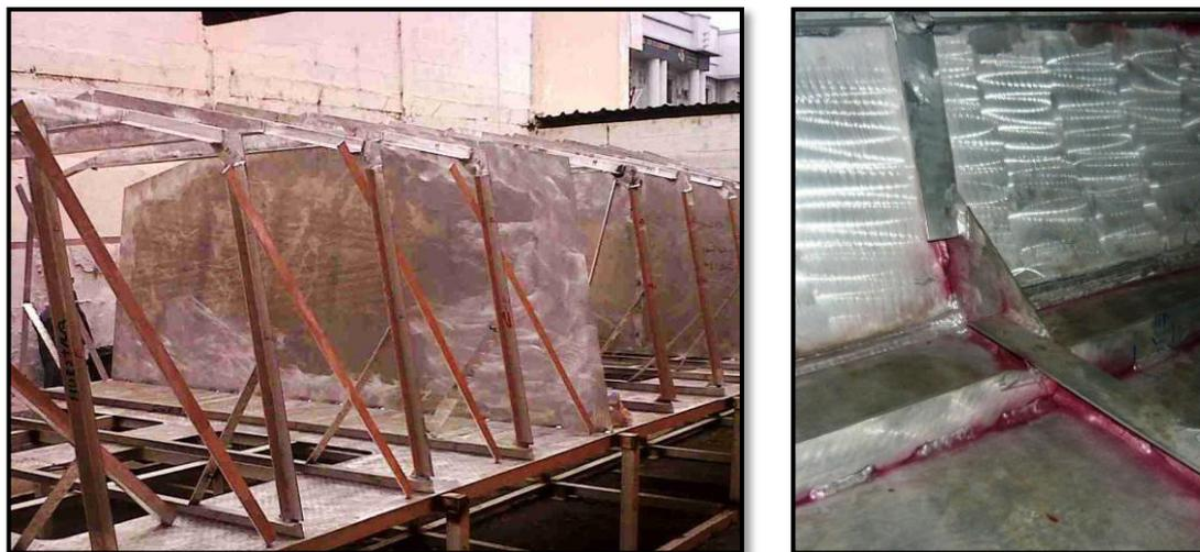
Figura No. 8 Conexión Estructural en la Lancha
