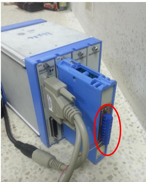
Figura No. 88 Terminal de Tornillo adaptada al equipo
