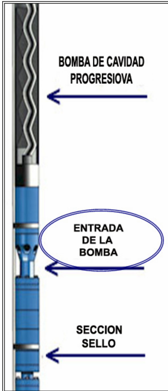
Fig. 2.13.- Entrada de la Bomba o Intake
