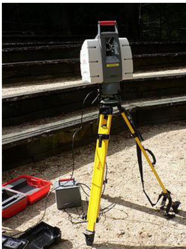
Figura 1.6 Tecnología LIDAR adaptada a un Trípode Fuente: David Monniaux, 2007
