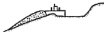
Figura 43 Empleo del tractor en corte de taludes laterales(c). (Fuente: Libro: Maquinaria de obras públicas II: Máquinas y equipos).
