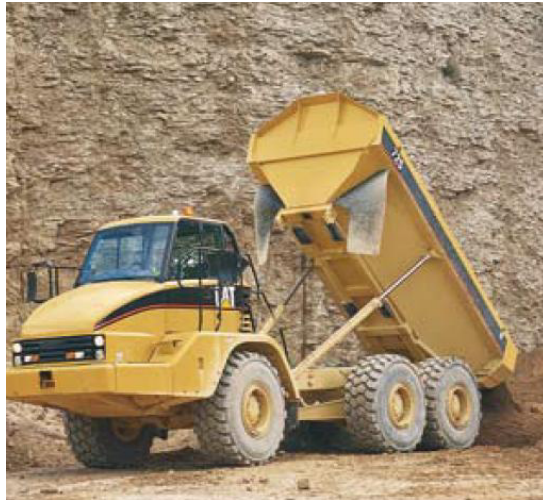
Figura 53. Volqueta en un Movimiento de Tierra. (FUENTE: Manual de maquinaria Caterpillar para movimiento de tierras, O. P. y Minería).
