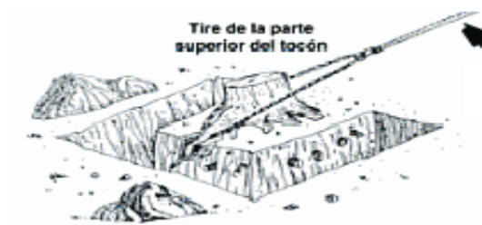
Figura 34. Arranque de tocones con raíces gruesas (FUENTE: Libro: Métodos sencillos para la acuicultura: Construcción de estanques).
