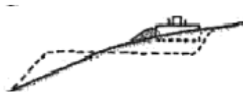
Figura 43 Empleo del tractor en corte de taludes laterales(a). (Fuente: Libro: Maquinaria de obras públicas II: Máquinas y equipos).
