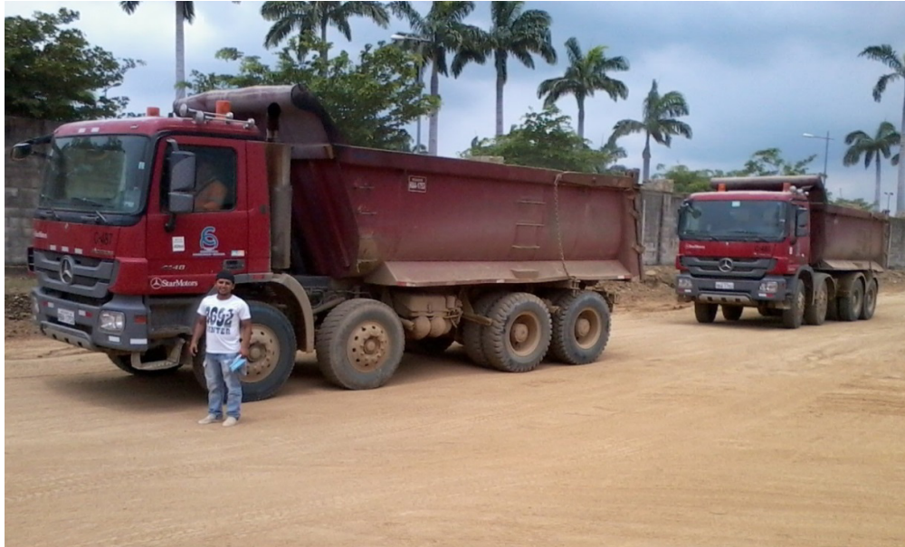
Figura 11.- Volquetas (18m 3 ) usadas para transporte de material, tomada por Gustavo Chiriboga en Isla Mococli
