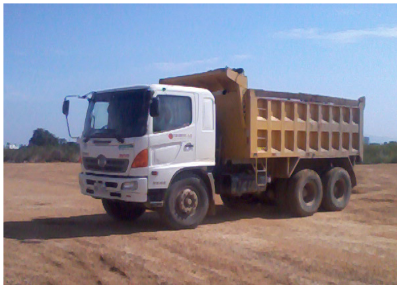
Figura 38.- Volqueta Hino-500, capacidad 9 m3, tomada en obra por Gustavo Chiriboga
