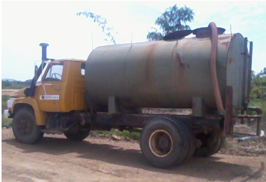
Figura 14.- Tanquero para Hidratación de Plataformas de Relleno, tomada en obra por Gustavo Chiriboga
