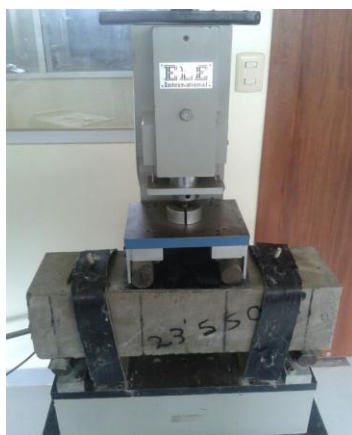
Figura 11: Viga sometida a Ensayo a Flexión 11
