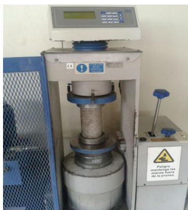
Fotografía 10: Espécimen sometido Ensayo a Compresión 10
