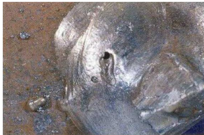
FIGURA 4.11.- POROS SUPERFICIALES ALARGADOS (VERMICULAR)
