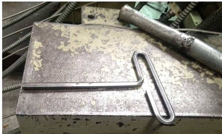
FIGURA 4. 33 LLAVE USADA PARA CALIBRAR LOS LABIOS DEL CABEZAL.
