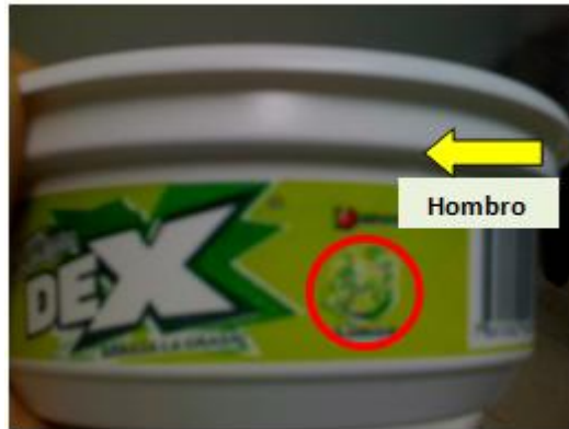
FIGURA 4.2 IMPRESIÓN INADECUADA EN EL DIBUJO DEL LIMÓN (ESPACIOS EN BLANCO)
