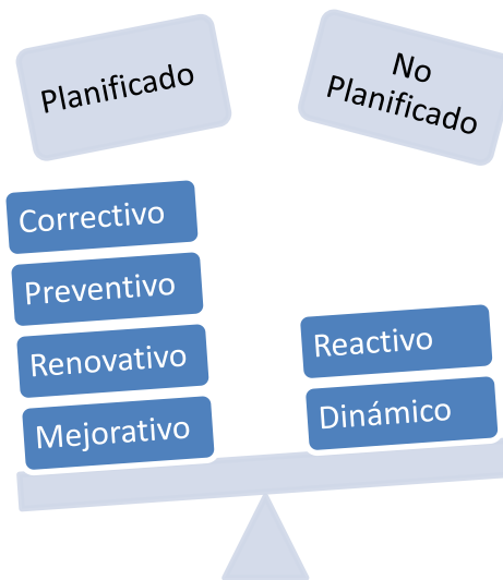
FIGURA 2.2. CLASIFICACIÓN DEL MANTENIMIENTO 6
