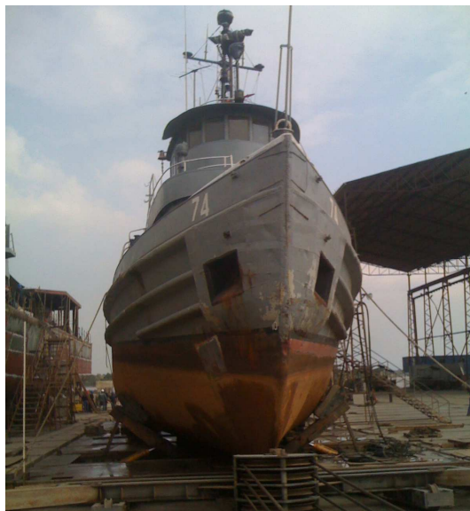
Figura N°31: Remolcador Sangay, varado utilizando los brazos hidráulicos de proa ya instalados.
