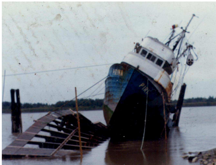
Figura N°11: Daño de la plataforma de varado.
