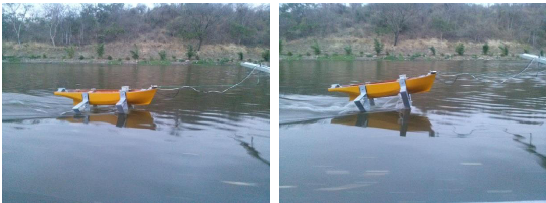
Figura 51: Variación del Angulo de Ataque de los Folios con Relación al Cambio de Asiento del Modelo.
