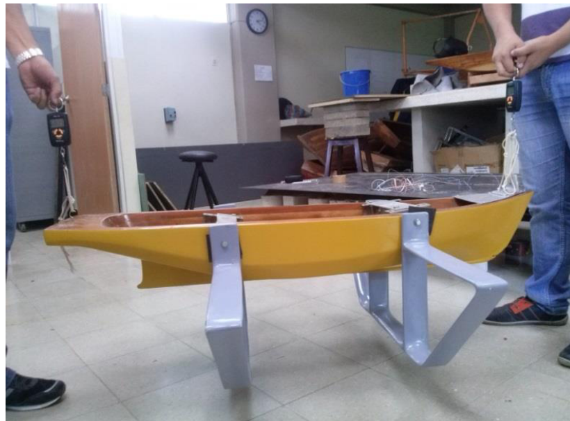
Figura 42: Determinación experimental del LCG, Cond. de Carga 1 con Folios.
