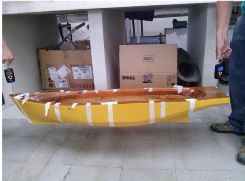
Figura 41: Determinación experimental del LCG, Cond. de Carga 1 sin Folios.
