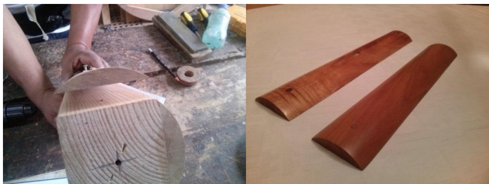
Figura 33: Construcción de los moldes machos de los Folios
