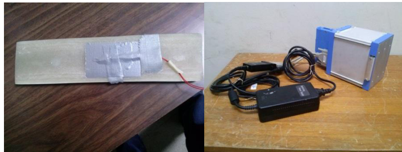
Figura 66 Extensómetro Instalado y Dispositivo para Adquisición de Datos.
