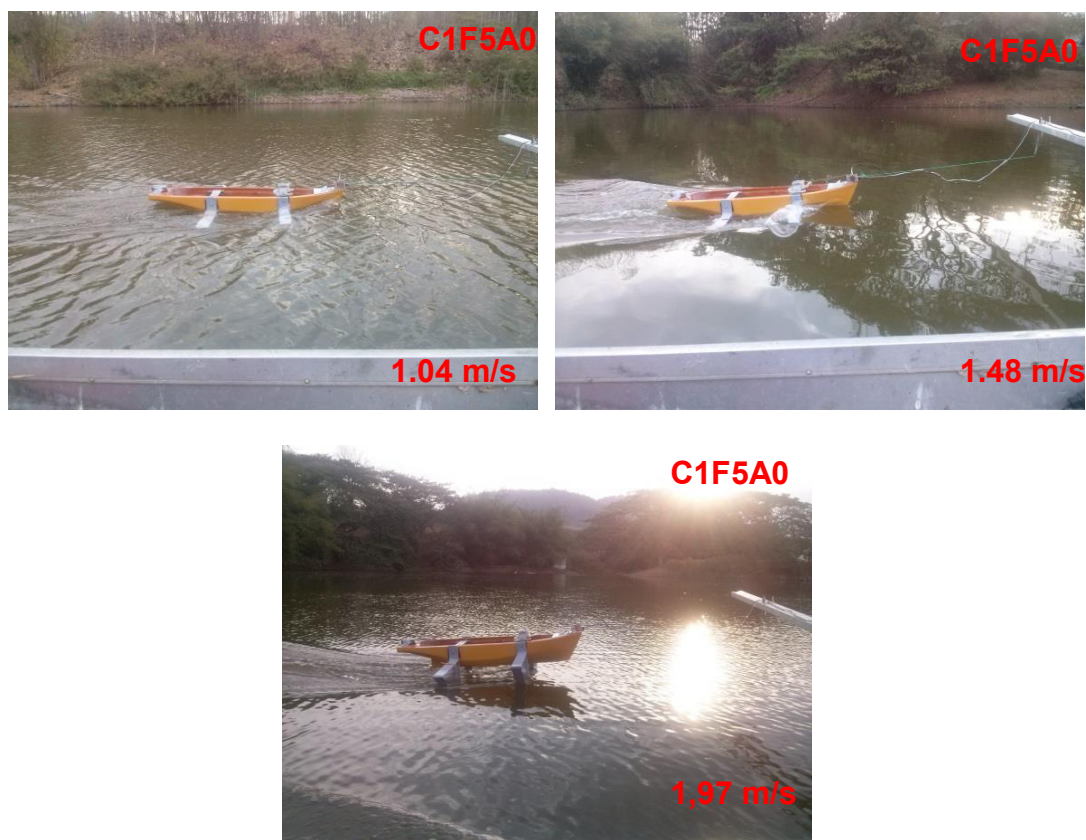
Figura 46: Proceso de Sustentación para el Modelo con Folio de Proa a 5^\circ y el de Popa a 0^\circ , Condición de Carga 1
