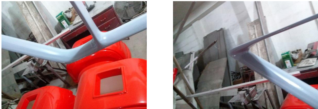
Figura 36: Acabado y Recubrimiento con Poliuretano
