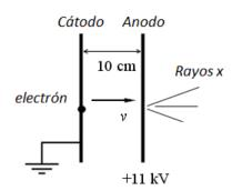
b) Cuando el generador de rayos X está funcionando, la densidad de carga superficial del cátodo y del ánodo son iguales en magnitud y opuestas en signo. ¿Cuál es la magnitud de  $\sigma$ ? (3 puntos)
