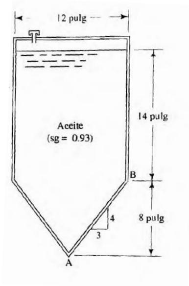
4. Calcule la magnitud de las componentes horizontal y vertical de la fuerza que el fluido ejerce sobre la superficie curva. Determine la magnitud de la fuerza resultante, su dirección y ubicación. La superficie mide 2m de longitud (20 puntos)
