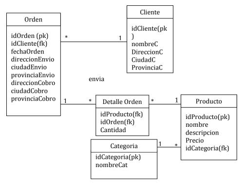
Para el siguiente modelo lógico diseñe un esquema para Data Warehouse en forma de estrella, el cual debe ser capaz de responder preguntas como:
