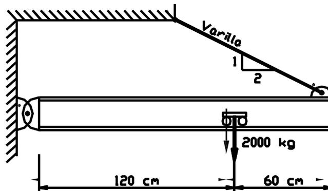
Empleando un factor de seguridad de 2.0, determine el diámetro de la varilla de acero que debería usarse en esta estructura. (7)
