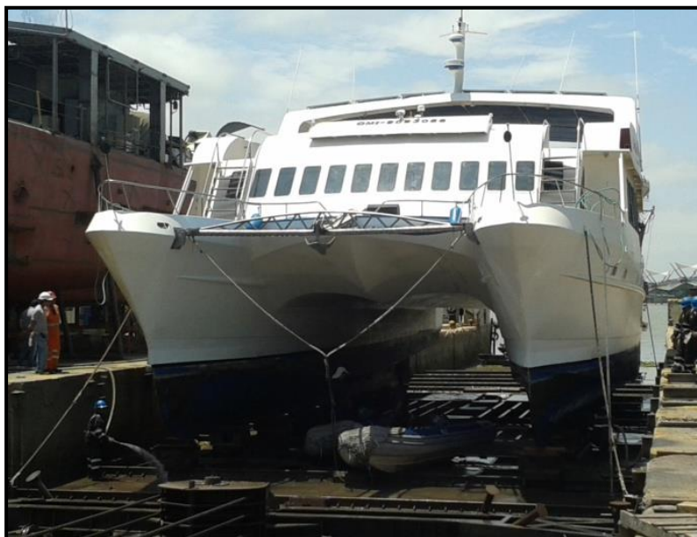
Figura 1. 3. Carenamiento sobre bloques o bancadas de madera
