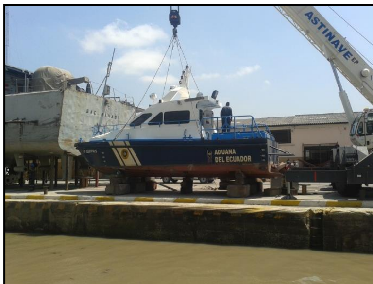
Figura 1. 4. Carenamiento con grúa
