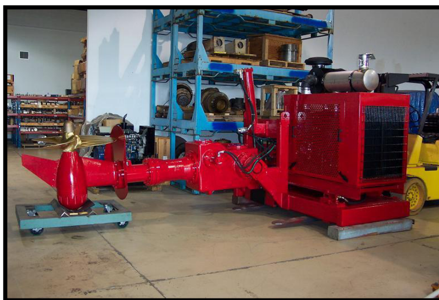
Figura IV.8 Unidad Hidráulica con propulsión azimutal
