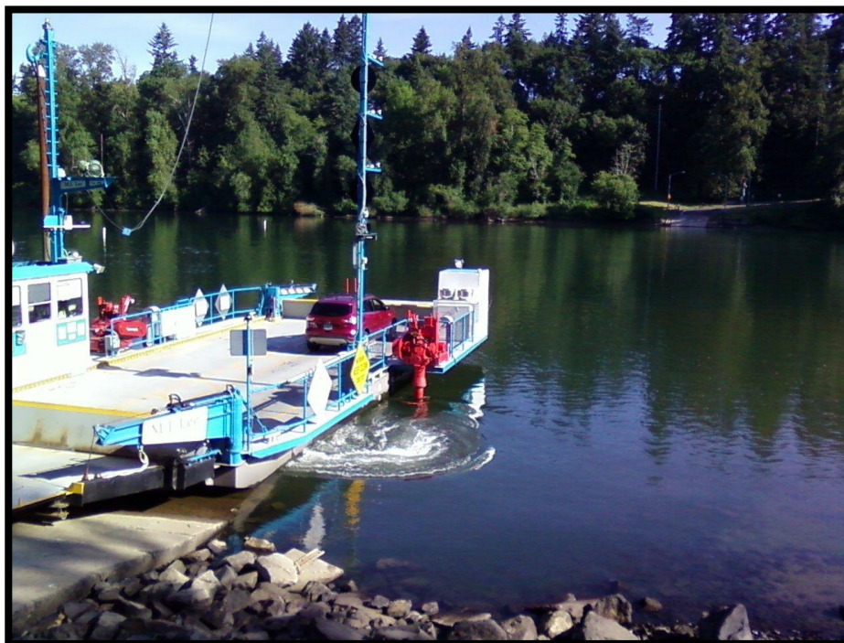
Figura IV.9 Barcaza usando unidades hidráulicas a los costados
