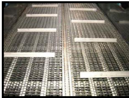
Figura II.8 Malla con retenedores instalados
