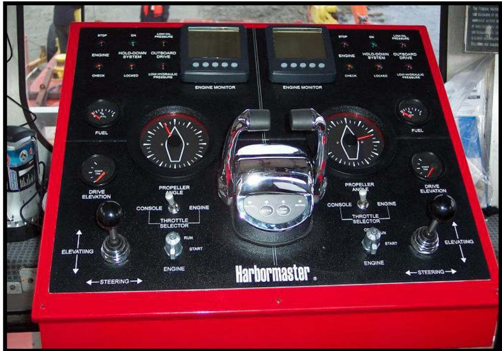
Figura IV.10 Control de mando de las unidades hidráulicas
