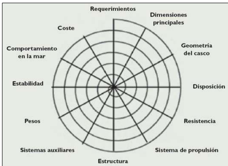
Figura No. 3 Espiral de diseño de buques
