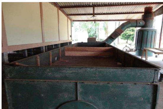
**FIGURA 1.11 SECADO ARTIFICIAL EN SECADOR.**
