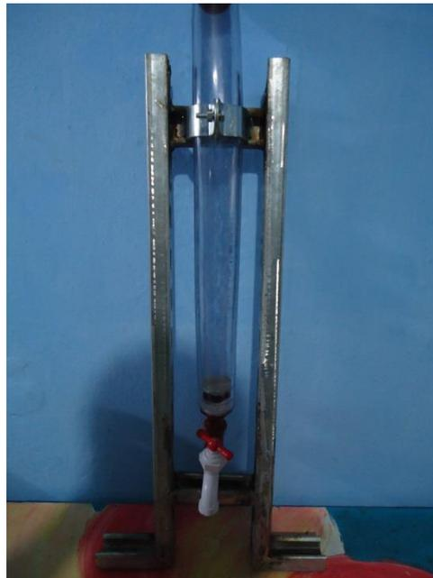
Figura 3-11 Filtro armado
