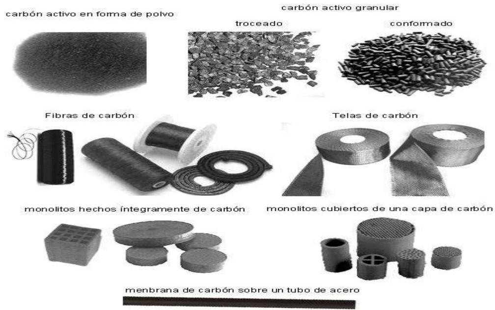
Figura 2-4 Tipos de carbón activado.
