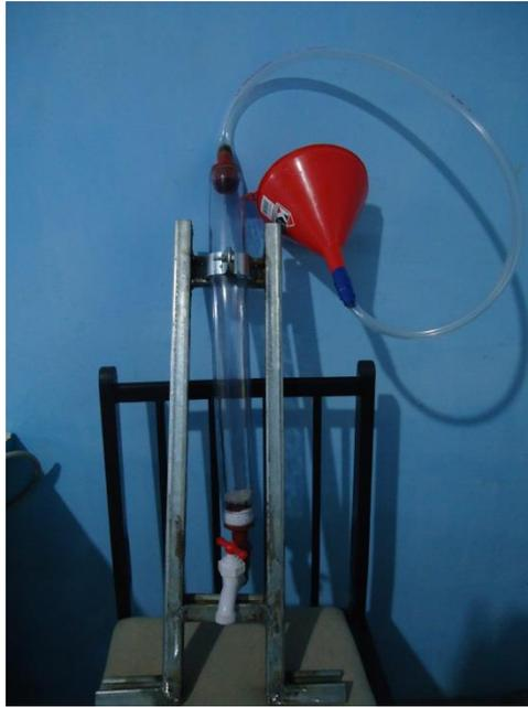
Figura 3–12 Filtro para carbón activado
