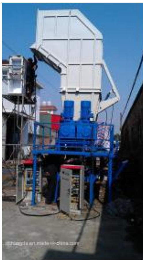
FIGURA 5.4: TRITURADORA DE 4 EJES
