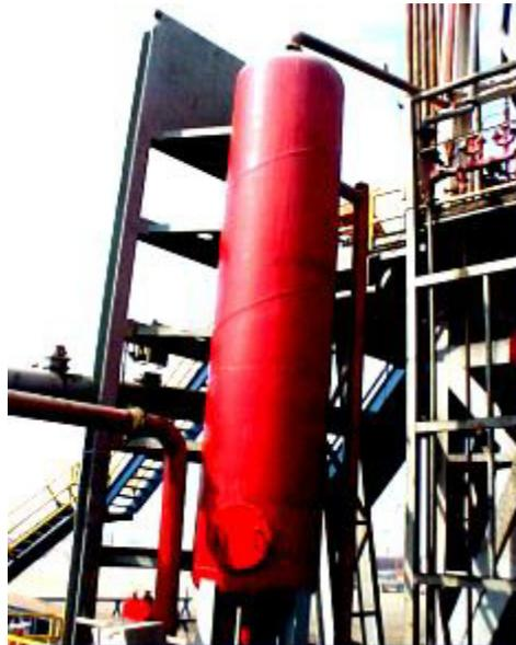
Figura 1.28 Separador de Gas (FUENTE: imagen tomada RIG Empresa DYGOIL)
