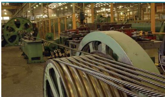
Figura 1.12 Línea o Cable de Perforación (FUENTE: Empresa IPH SAICF)
