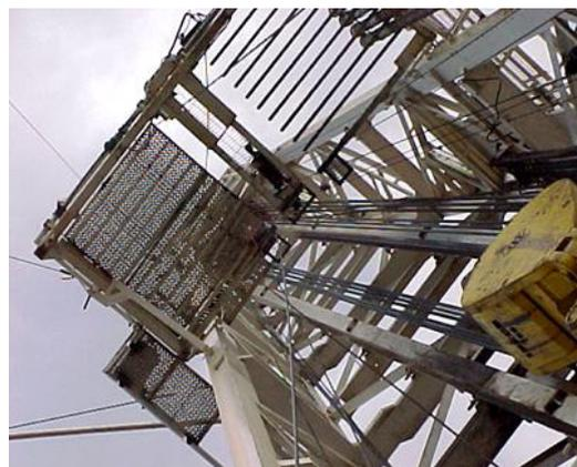
Figura 1.6 Plataforma del Encuellador (FUENTE: Imagen tomada RIG Empresa DYGOIL)
