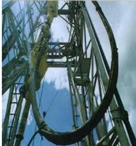
Figura 1.24 Manguera Vibradora (FUENTE: Imagen Blogspot madriguera del petrolero)
