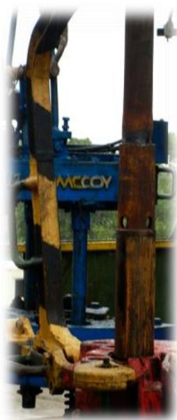
Figura 1.15 Llaves de Potencia de enrosque y desenrosque (FUENTE: Imagen tomada RIG Empresa DYGOIL)
