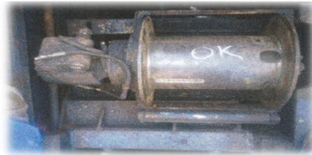
Figura 1.5 Guinche (FUENTE: Imagen tomada RIG Empresa DYGOIL)
