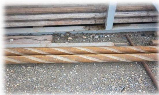
Figura 1.16 Barra de Perforación (FUENTE: Imagen tomada RIG Empresa DYGOIL)
