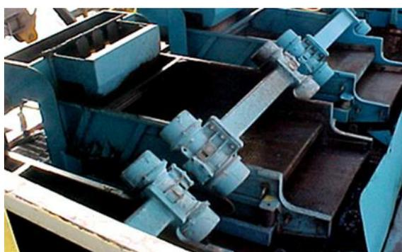
Figura 1.27 Zarandas (FUENTE: imagen tomada RIG Empresa DYGOIL)
