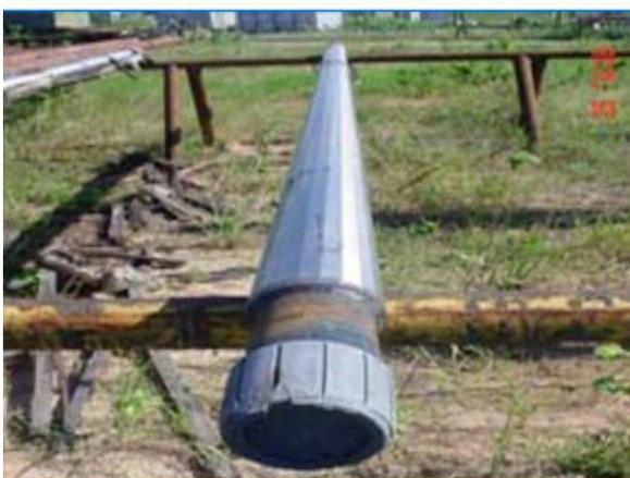
Figura 2.37 Estator (FUENTE: MISSION PETROLEUM)
