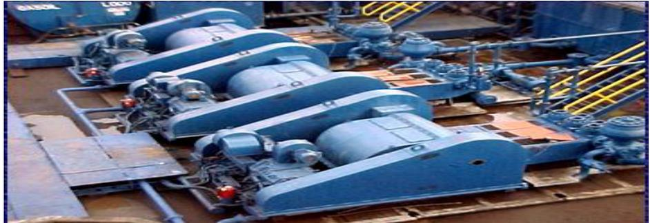
Figura 1.20 Bomba Triplex (FUENTE: imagen tomada RIG Empresa DYGOIL)
