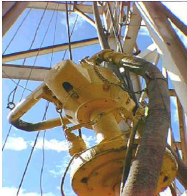
Figura 1.22 Manguera Rotatoria (FUENTE: imagen tomada RIG Empresa DYGOIL)
