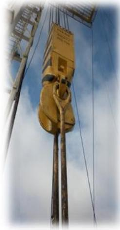
Figura 1.10 Bloque viajero (FUENTE: Imagen tomada RIG Empresa DYGOIL)
