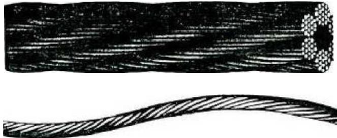
NOTA: Cuando por algún motivo se rompe un alambre en cables preformados, el alambre roto permanece en su posición; sin embargo, el no preformado al romperse tiende a desprenderse del cable.
