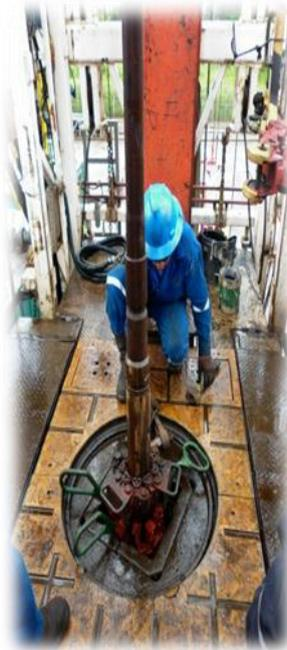
Figura 1.14 Mesa Rotaria (FUENTE: Imagen tomada RIG Empresa DYGOIL)
