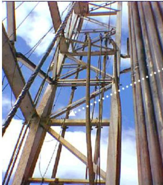
Figura 1.23 Tubo Vertical (FUENTE: imagen tomada RIG Empresa DYGOIL)
