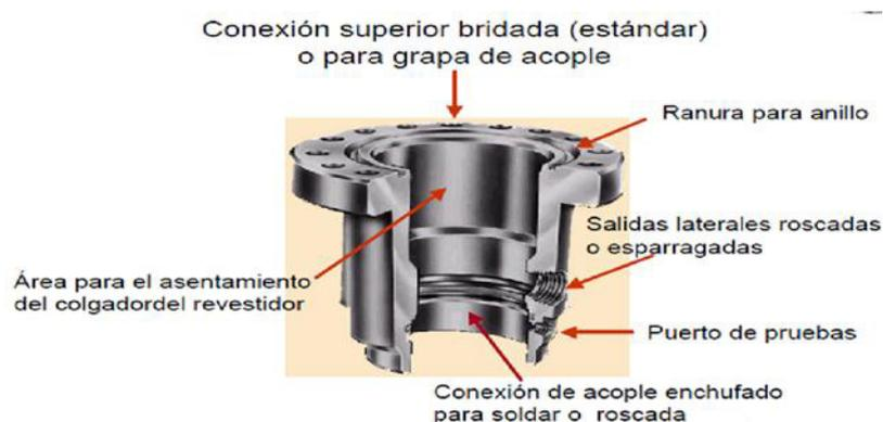
Figura 1.43 Sección "A" o cabeza de Casing - Casing head - base o cubierta del cabezal (FUENTE: ppt FUNDAMENTOS DE INGENIERIA)
