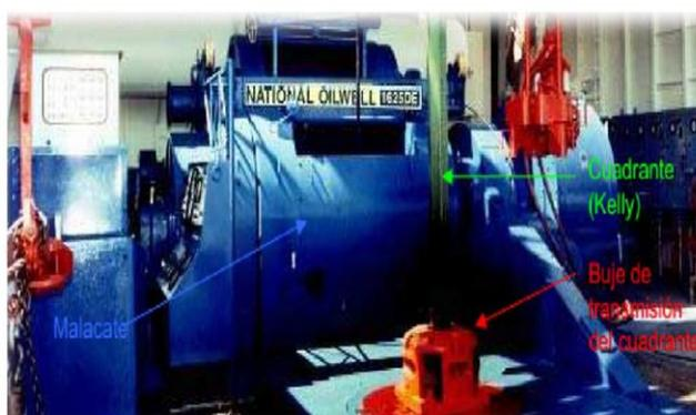
Figura 1.8 Malacate (FUENTE: Imagen tomada RIG Empresa DYGOIL)
