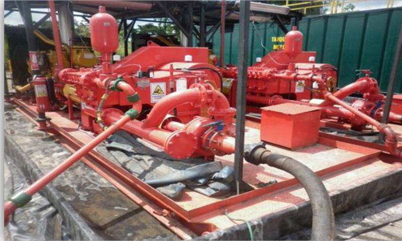
Figura 1.19 Bomba Dúplex (FUENTE: imagen tomada RIG Empresa DYGOIL)
