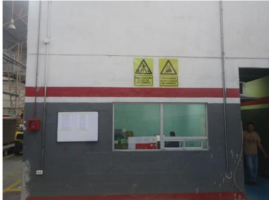
**Figura 3.22. Señalética de Paso de Peatones y montacargas colocadas en la planta.**
