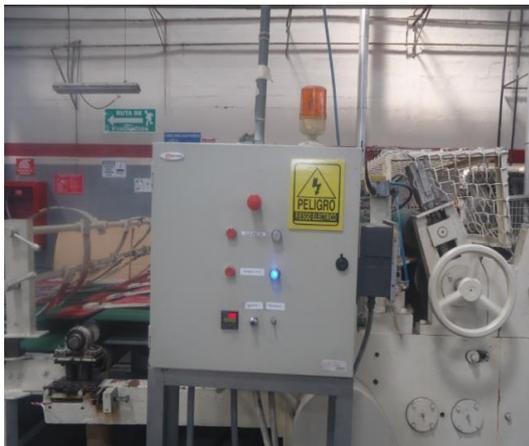
**Figura 3.19. Señalética de Riesgo de Eléctrico colocada en tablero de control.**
