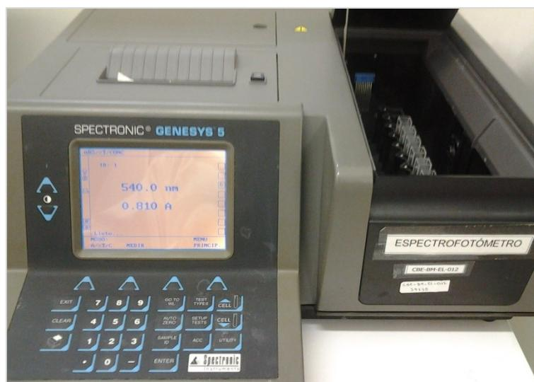
**FIGURA 2.8** Espectrofotómetro para medir la absorbancia
