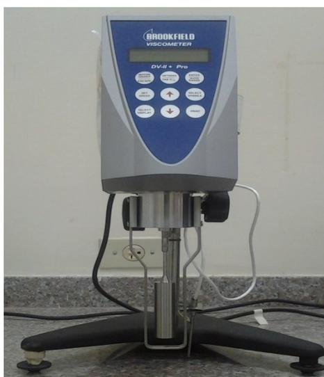
**FIGURA 2.5** Viscosímetro rotacional BROOKFIELD
