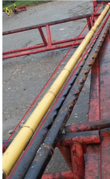
Figura # 53. Martillo, ensamblaje de fondo pozo O-1i.
