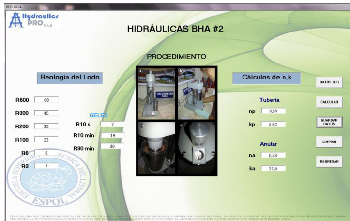
Anexo XXV. Datos Reológicos BHA #2, Software Hydraulics Pro V1.0 del pozo O-1i, Visual Basic 6.0.
