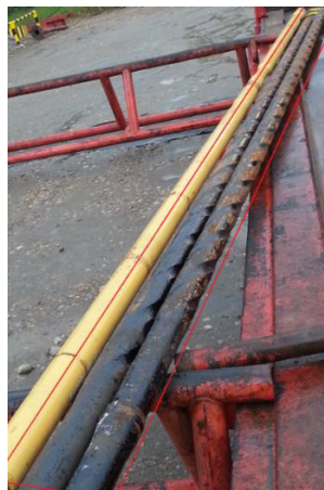
Figura # 46. Drill Collars, ensamblaje de fondo pozo O-1i.
