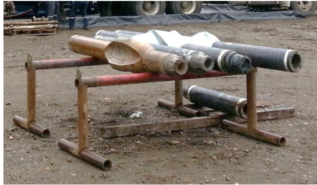
Figura # 51. Estabilizadores, ensamblaje de fondo pozo O-1i.
