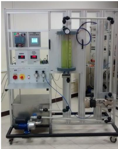
**Figura. 1.** Planta de nivel Gunt Hamburg RT-450
