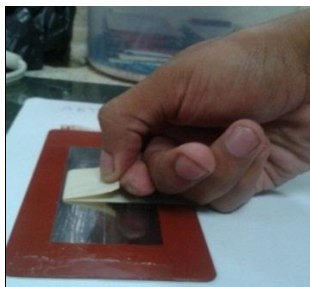
FIGURA 2.31. ENSAYO DE ADHERENCIA SOBRE PLACAS NORMALIZADAS
