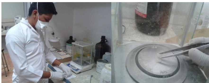
FIGURA 3.58. PESAJE DE PROBETA EN PRUEBA DE HINCHAMIENTO
