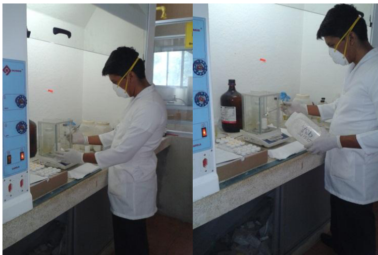
FIGURA 3.63. PESAJE DE RESINAS-AMINA-ARCILLA E INHIBIDOR
