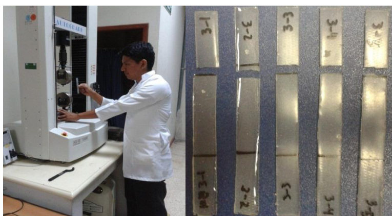
FIGURA 3.66. COLOCACIÓN DE PROBETA EN LA MEU Y PROBETAS AL FINAL DEL ENSAYO
