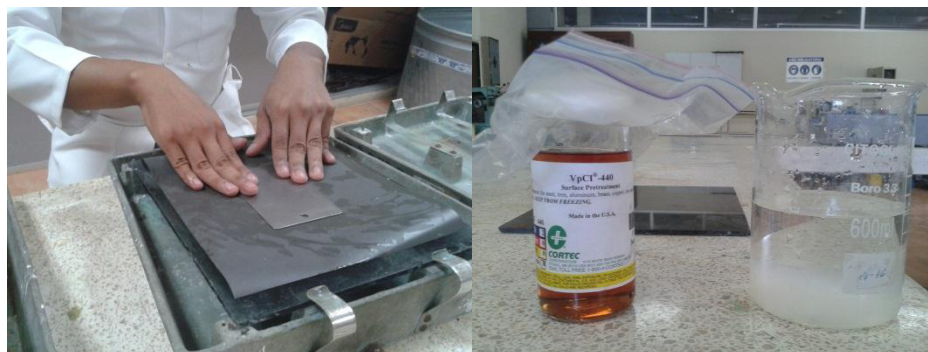
FIGURA 3.70. LIJADO DE PLACAS METÁLICAS NORMALIZADA
