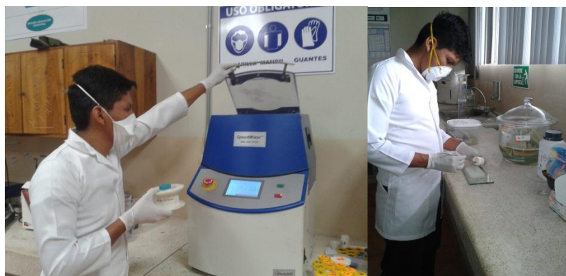
FIGURA 3.64. MEZCLADO EN EL SPEED MIXER Y VERTIDO DE MUESTRAS EN LOS MOLDES
