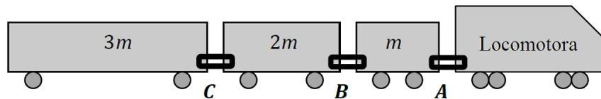
masa: el primer vagón tiene masa  $m$ , el segundo vagón tiene masa  $2m$ , y el último vagón tiene masa  $3m$ . Los vagones están conectados por enlaces A, B, y C, como se muestra. ¿Qué enlace experimenta la menor fuerza cuando el tren acelera hacia la derecha?
