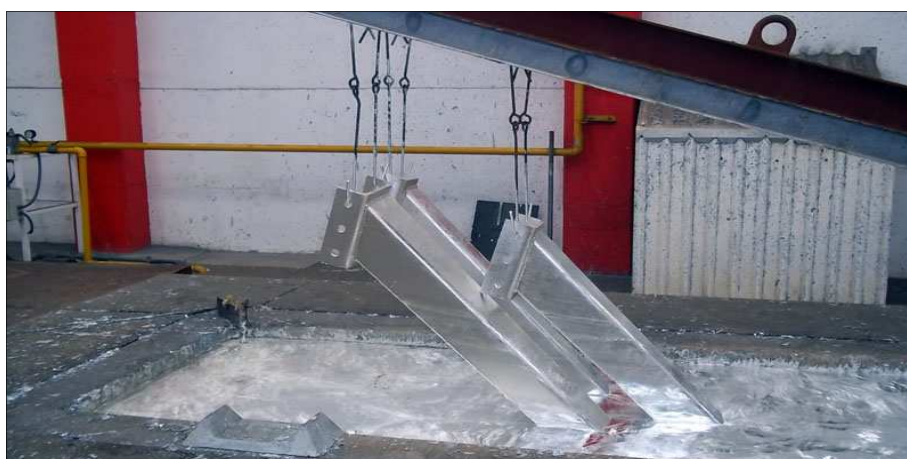
FIGURA 4.5: PIEZAS EN PROCESO DE GALVANIZADO POR INMERSIÓN EN CALIENTE
