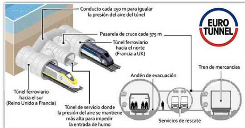
FIGURA 2.2. ESQUEMA DEL EUROTÚNEL
