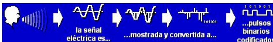
FIGURA 4.8. SEÑAL ANÁLOGO A SEÑAL DIGITAL
