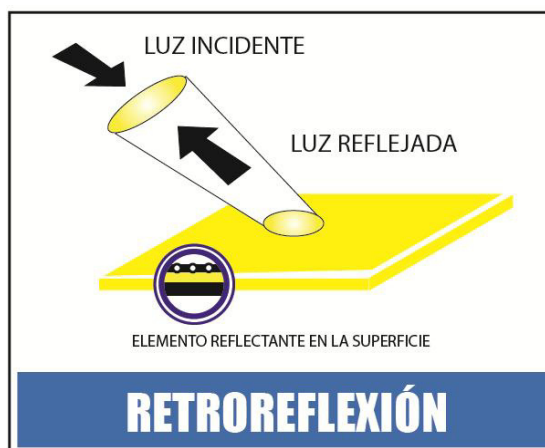
Figura 3.3. Retroreflexión. Adaptado de (Frédéric Boily, 2014).
