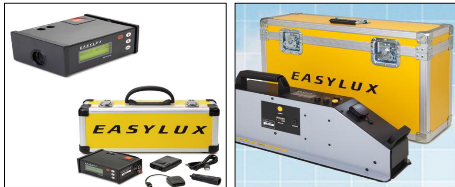
Figura 4.1. Retroreflectómetro manual Vertical y Horizontal. Fuente: (MTO, 2014)
