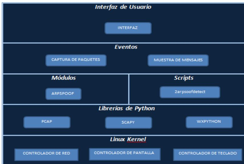
**Figura # 3.6. Arquitectura de aplicación de detección de ARP Spoofing**
