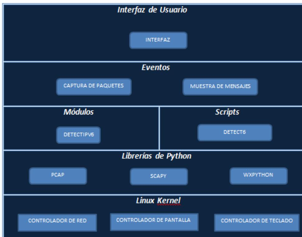
**Figura # 3.9. Arquitectura de aplicación de detección de ataques IPv6**
