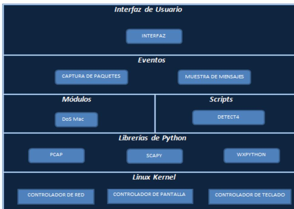
**Figura # 3.12. Arquitectura de aplicación de detección de DoS Invalid MAC Spoofing**
