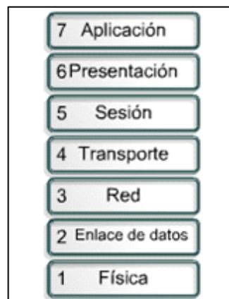
**Figura # 2.1. Capas del Modelo OSI**
