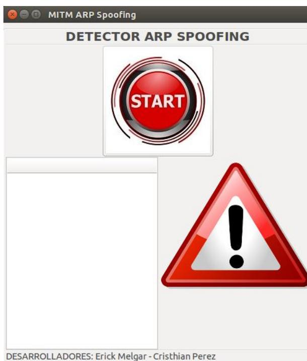
**Figura # 4.6. Detección del ataque “ARP Spoofing”**
