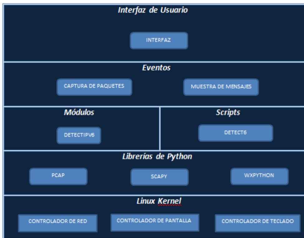
**Figura # 3.3. Arquitectura de aplicación de detección de ataques IPv6**
