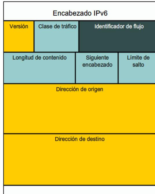
**Figura # 2.5. Encabezado IPv6**
