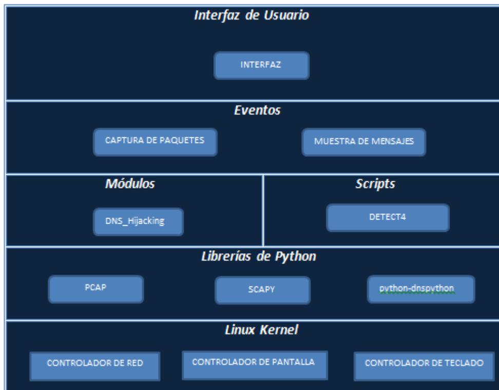
**Figura # 3.15. Arquitectura de aplicación de detección de DNS Hijacking**
