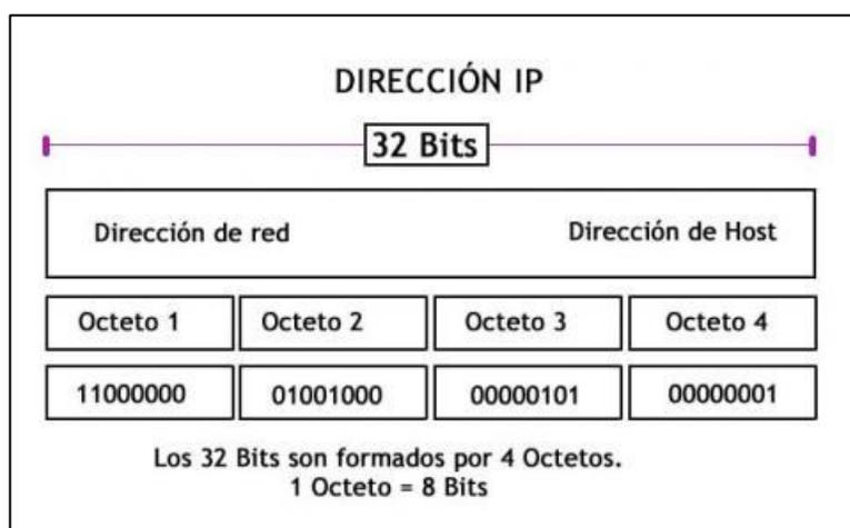
**Figura # 2.2. Ejemplo de una dirección de red IPv4**
