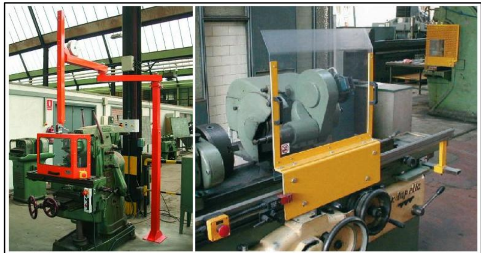
FIGURA 1.11. PROTECCIÓN EN MÁQUINAS HERRAMIENTAS
