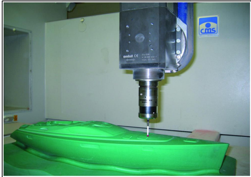
FIGURA 1.5. MECANIZADO DE PROTOTIPO DE BARCO EN CNC
