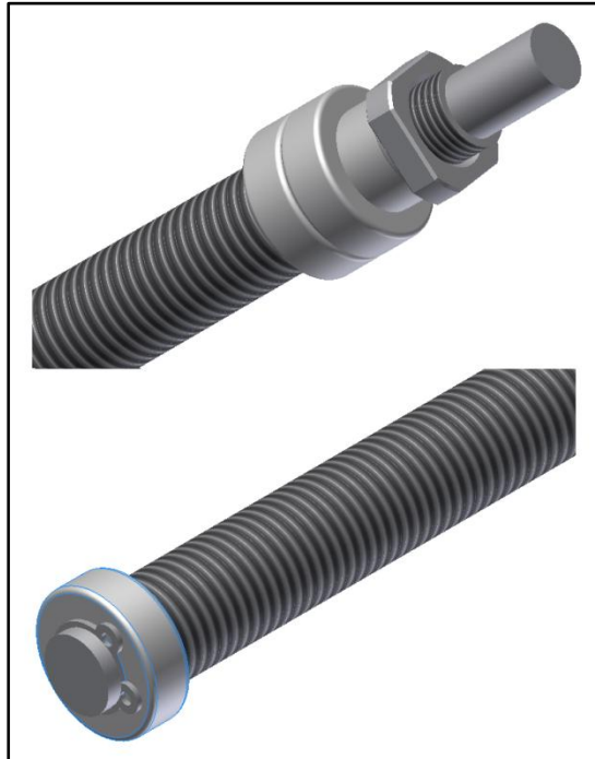
FIGURA 3.16. DISPOSICIÓN RODAMIENTOS AXIALES, TORNILLO DE POTENCIA, EJE Z
