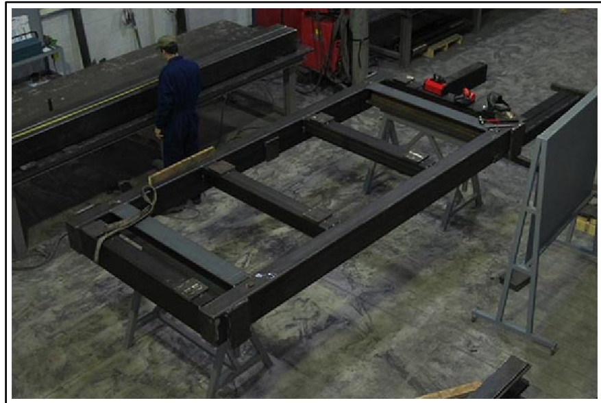
FIGURA 2.5. ESTRUCTURA BASE A PARTIR DE PERFILES DE ACERO SOLDADOS
