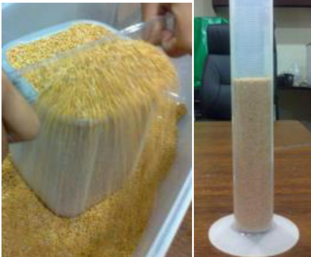
Desplazamiento de semillas y medición en probeta
