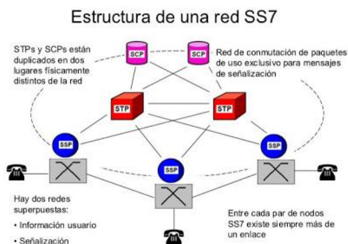
Figura 2.1. Componentes de una red SS7 [5].
