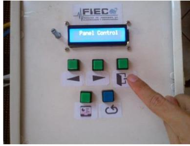
**Figura 4.18** Botonera del panel de control para el cierre de la puerta.
