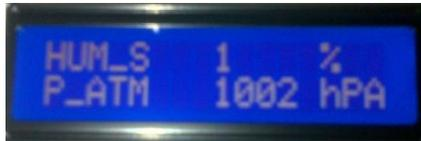
**Figura 4.22** Pantalla del sensor de humedad del suelo y Presión Atmosférica.
