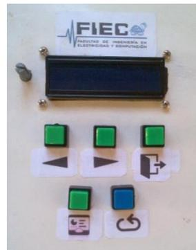
**Figura 4.15** Panel de Control con sus botoneras de navegación.
