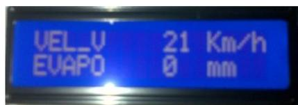
**Figura 4.23** Pantalla del sensor de velocidad del viento y del nivel del evaporímetro.
