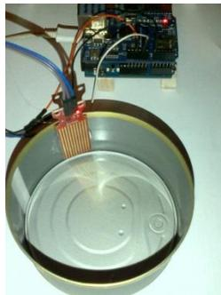
**Figura 4.4** Evaporímetro.
