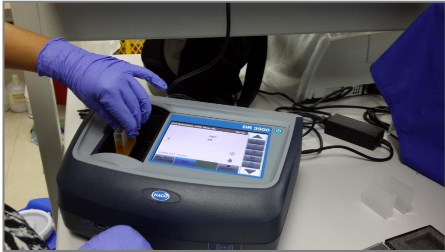
Colocación de las cubetas rectangulares de 50 mm una vez vertido la muestra, posteriormente el Espectrofotómetro determina las concentraciones de manganeso presentes en el agua de pozo.
