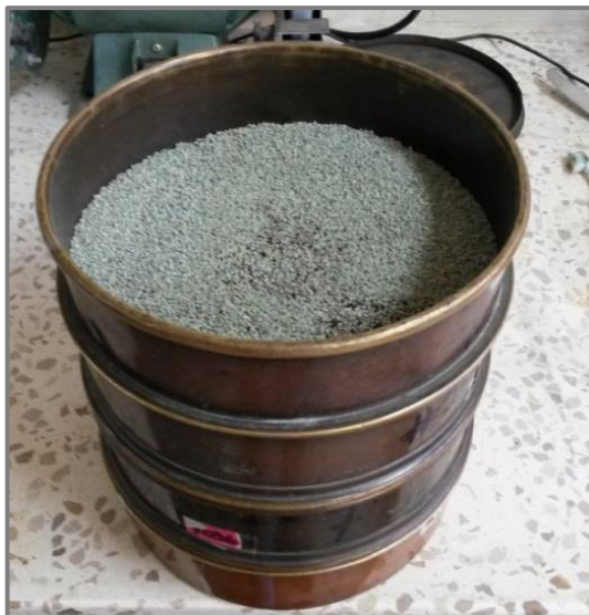
Figura 48: Tamices empleados para la clasificación del material y eliminación de impurezas volátiles, previo al lavado.
