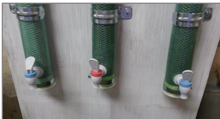
Figura 53: Columnas adaptadas a la madera de plywood mediante las grapas, con la finalidad de mantenerlos vertical durante los procesos de filtración.
