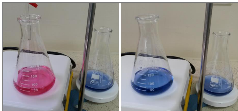
Figura 55: Análisis de la concentración de la dureza, previo a la titulación y después de la misma.
