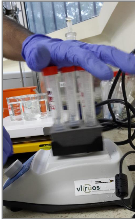
Agitación de las muestras provenientes del pozo de Abastecimiento Público "Vargas Torres", posteriormente se vierten los reactivos restantes para luego finalizar con la lectura de las concentraciones. El análisis fue realizado en el laboratorio del ICQA.
