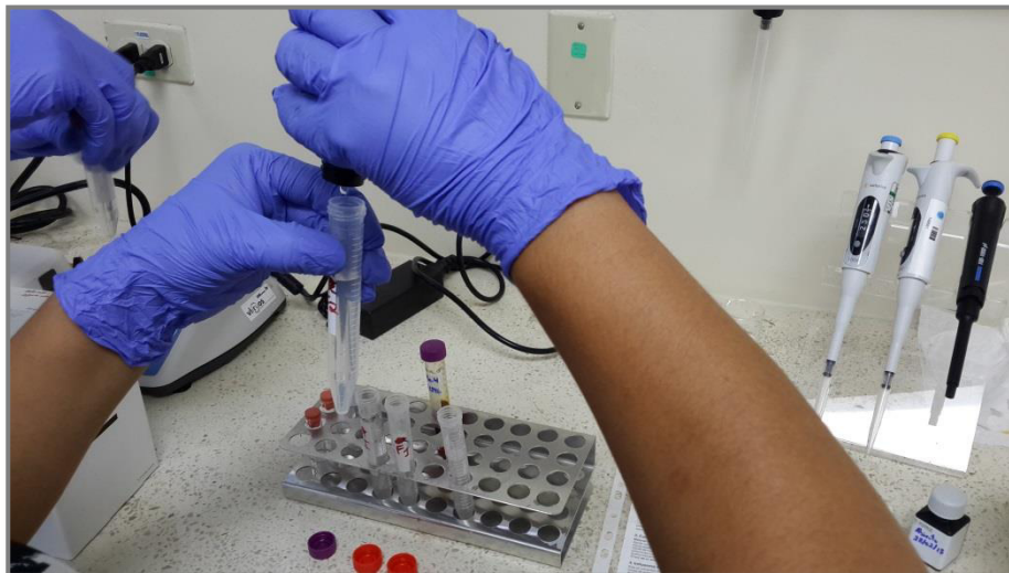
Colocación del Reactivo Mn-3, el cual consiste en añadir tres gotas de cianuro potásico a cada muestra, luego se agita y posteriormente se vierte el reactivo Mn-4. Finalmente se deja reposar la muestra por diez minutos.
