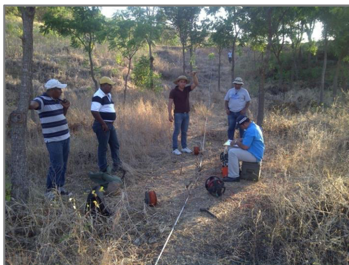
Figura 28: Sondeo Eléctrico Vertical (SEV), toma de datos en campo.
