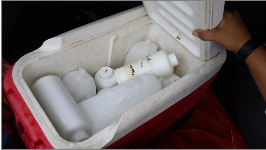
Muestras tomadas en ambos pozos, colocados en una hielera previo al traslado para el análisis de contaminantes en el laboratorio.
