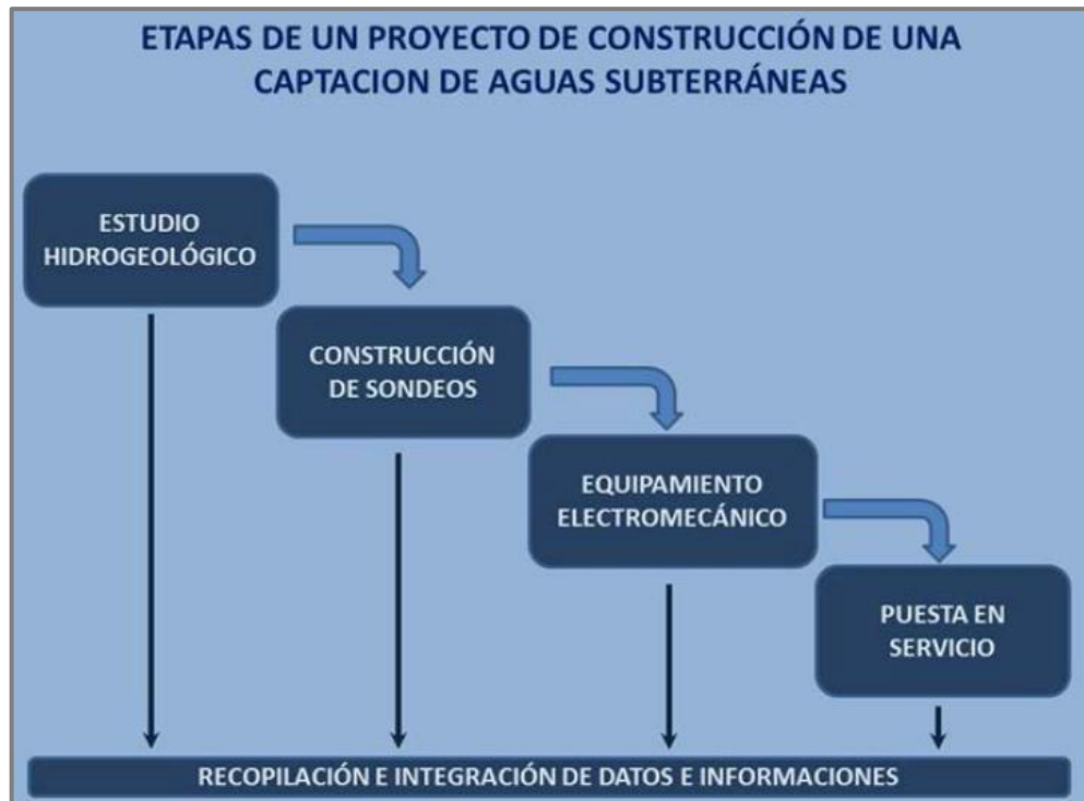
Figura 27: Modelo esquemático del proceso de captación de agua (Herrera & Castilla, 2012).
