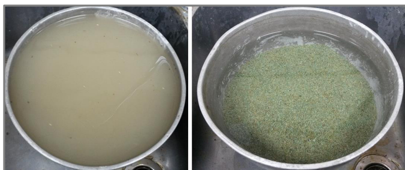
Figura 50: Material zeolítico previo al lavado y después del lavado.
