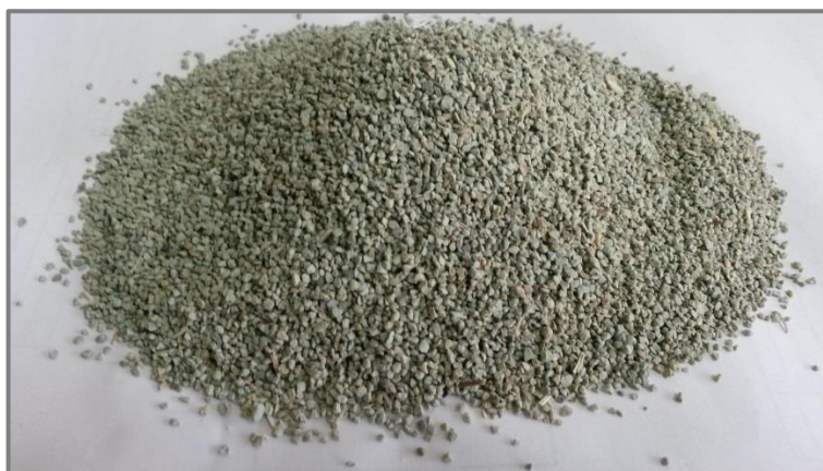
Figura 46: Material Zeolítico mezclado con diferentes granulometrías.
