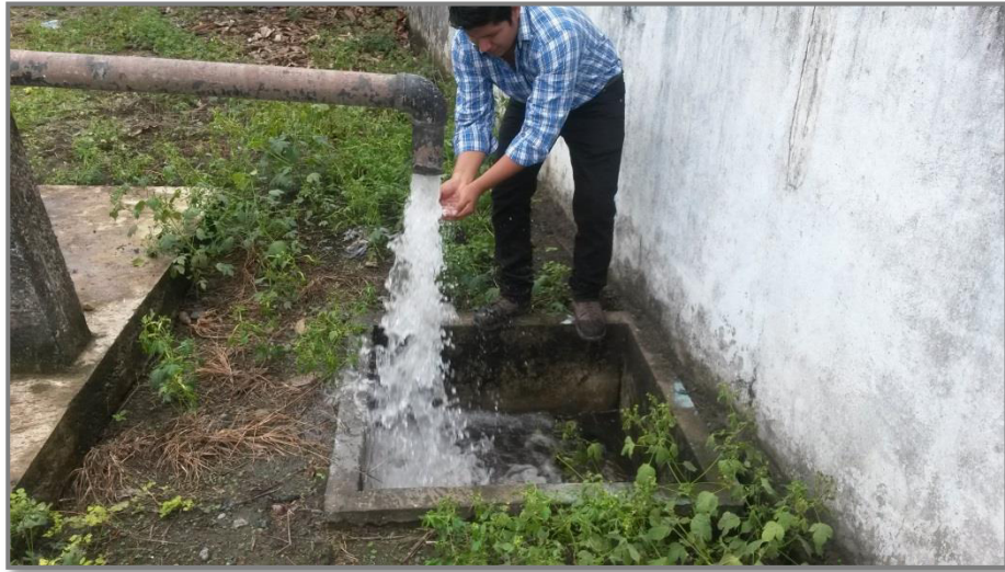
Previo a la toma de muestra el agua se deja circular por 5 minutos aproximadamente, en el pozo de Abastecimiento Público "El Paraíso".
