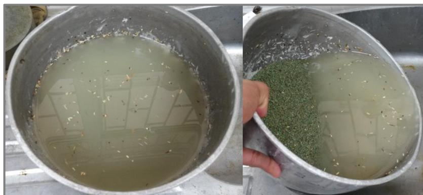
Figura 49: Lavado del material zeolítico con presencia de impurezas suspendidas.
