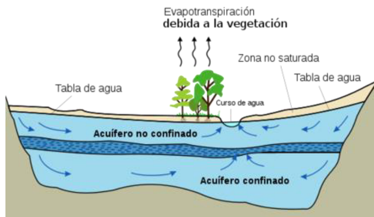
Figura 15: Representación gráfica de un río efluente; Flujo de agua desde el acuífero hacia el río (Acuifers, 2011).
