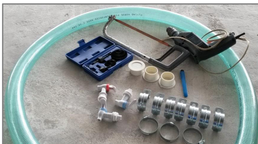
Figura 47: Material implementado para el armado de los tres filtros.
