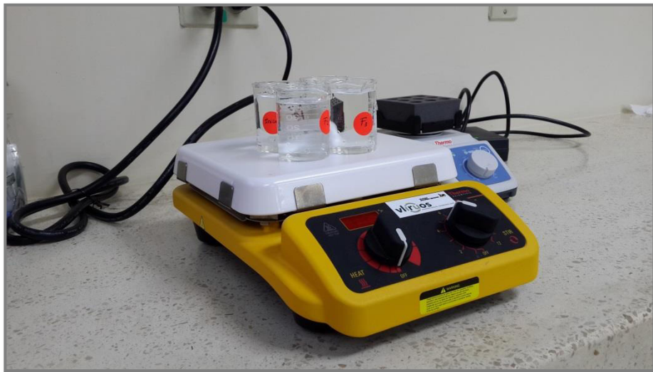
Agitación de las muestras provenientes del pozo “Vargas Torres”, previo al análisis de manganeso en el laboratorio del ICQA.
