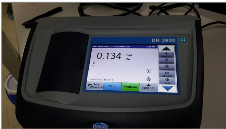
Medición de la concentración de manganeso presente en el agua de pozo de Abastecimiento Público "Vargas Torres". La medición corresponde a una de las muestras posterior al proceso de filtrado.
