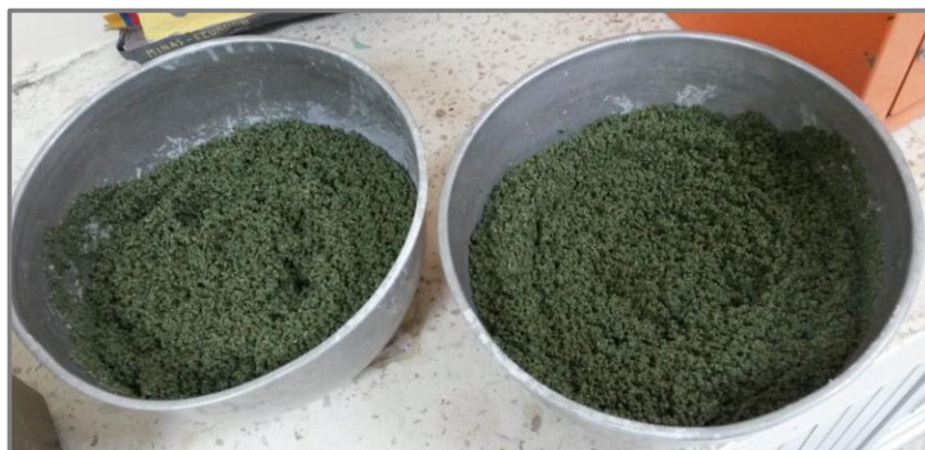
Figura 51: Zeolita correspondiente al retenido en la malla #16 y malla #20, previo al proceso de secado.
