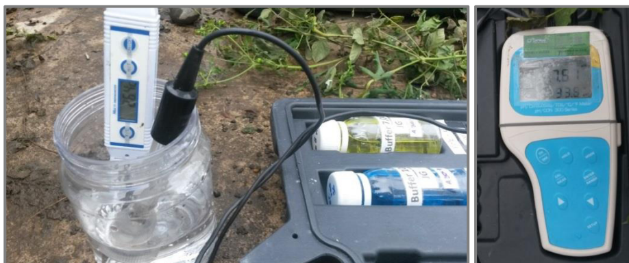
Figura 45: Medición de la temperatura y pH, Previo a la toma de muestra, en el pozo denominado "El Paraíso".
