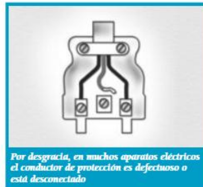
Figura 137. Conductor de protección desconectado.
