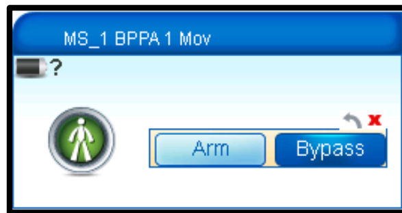
Figura 4.118: Opción Bypass del sensor de movimiento escogida en el retraso de 12 horas.
