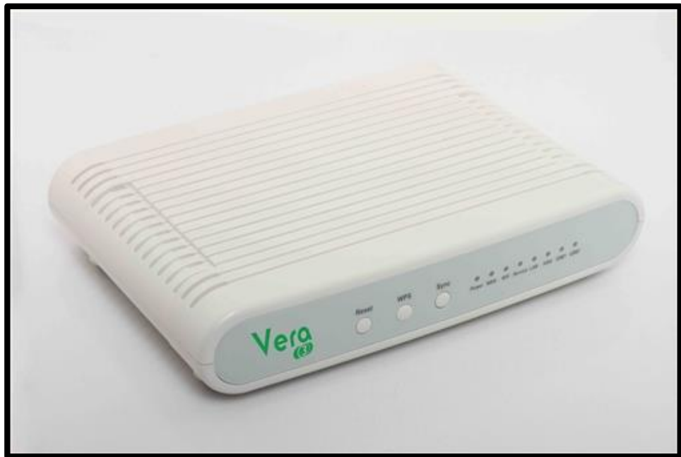
Figura 4.2: Dispositivo controlador del sistema domótico VERA3.
