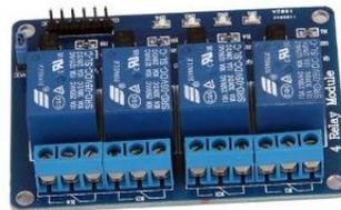
**Figura 4.3 Módulo de 4 relés de 5v.**
