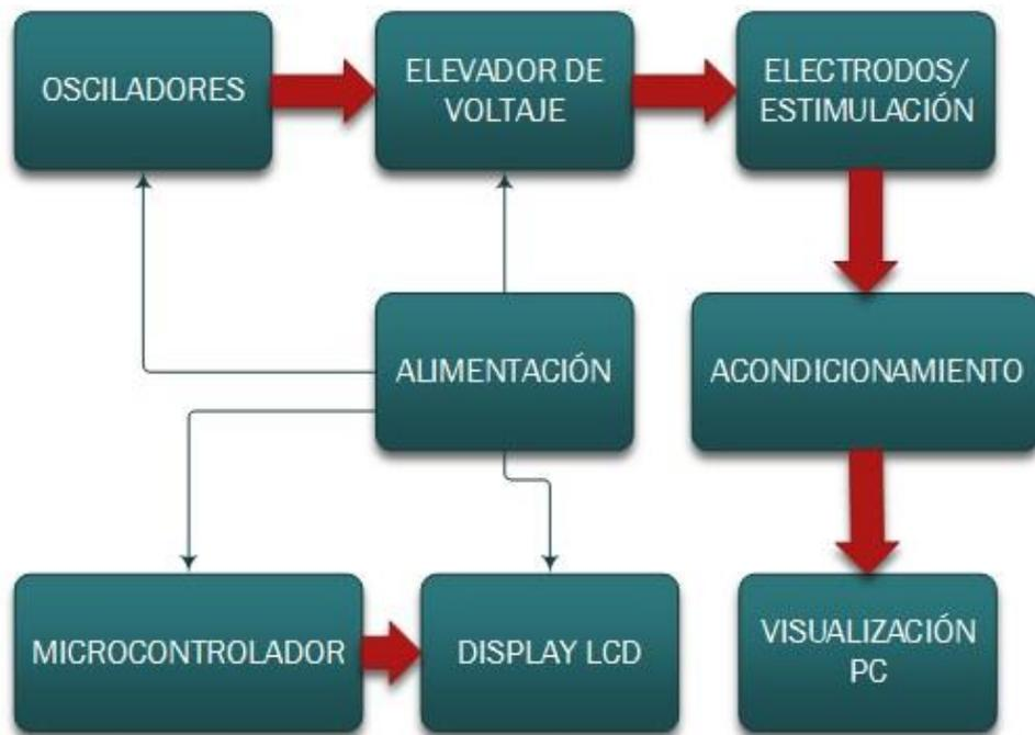
**Figura 2.2 Diagrama de bloque del circuito estimulador**
