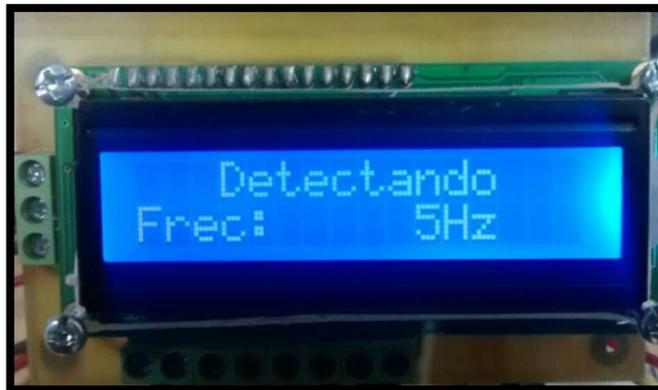
**Figura 4.2 Visualización de frecuencia en LCD**
